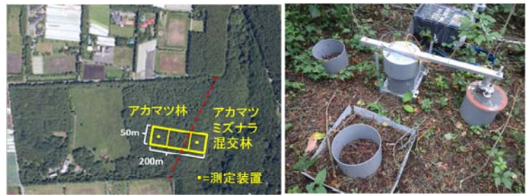
調査地マップ (左) と自動開閉式測定装置 (右)
