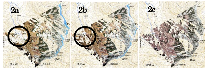
図 2 2a 全撮影パラメータを推定して作成したオルソ画像、2b 撮影位置と画角を与えて作成したオルソ画像、2c オルソ航空写真
